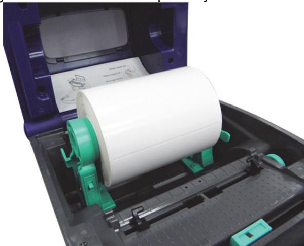
4. Disponga el selector de bloqueo del soporte de medios en **Bloqueo** (abajo) para poder sujetar el rollo de etiquetas firmemente.
