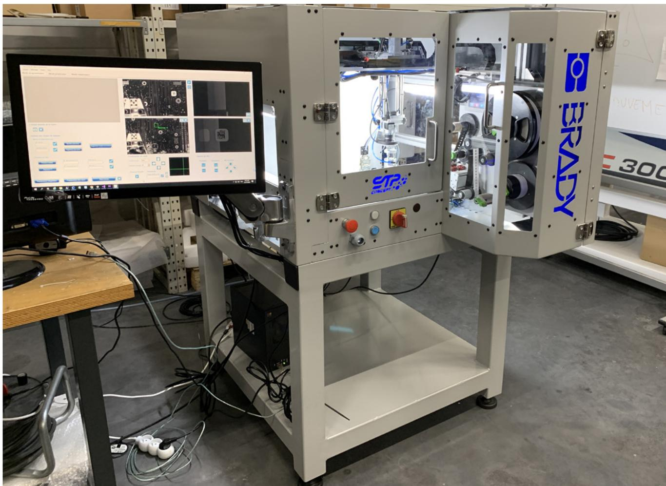
Stampa e applica automaticamente etichette per una tracciabilità affidabile ovunque su qualsiasi scheda elettronica standard, singola o multipla in 3 secondi.
