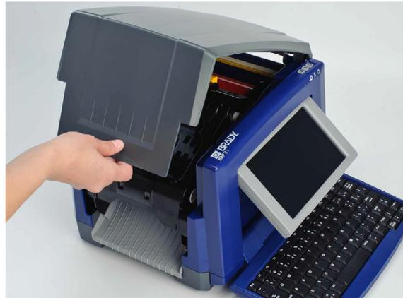
2. Suelte el seguro en la cubierta del transfer [2] y oscile el cartucho del transfer para abrir.
