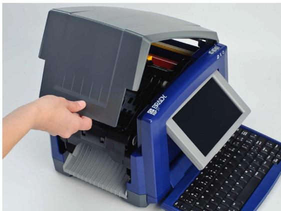
2. Suelte el seguro de la cubierta del transfer [2] y oscile para abrirla.
