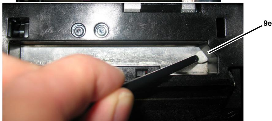
5. Cierre la cuchilla de corte empujando hacia arriba en la deslizadera de salida hasta que las orejetas del cortador se ajusten en su lugar.
