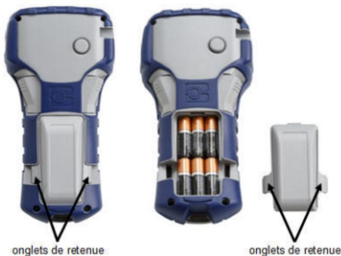
2. Insérez six piles alcalines AA ou le bloc-pile rechargeable BMP21-PLUS-BATT offert en option. (N'utilisez pas des piles AA rechargeables ou Ultimate Lithium AA.)
