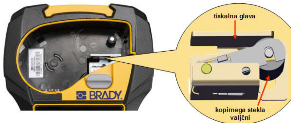
Slika 9 • Tiskalna glava in tiskalni valj v prostoru za kartušo
