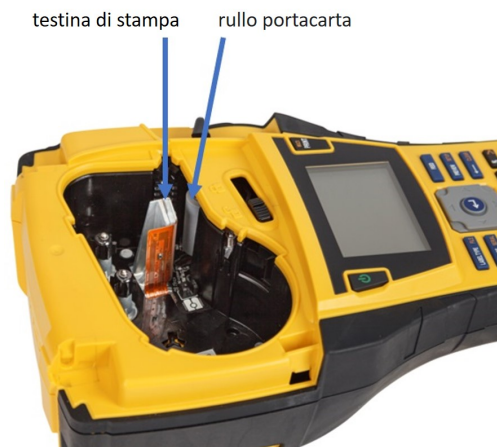
Figura 39 • Testina di stampa e rullo portacarta nell'alloggiamento della cartuccia
