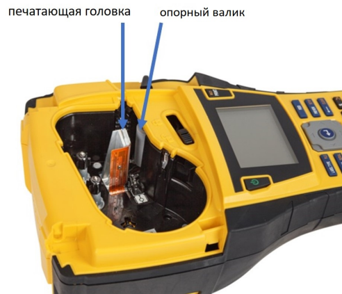
Рисунок 39. Печатающая головка и валик в отсеке для картриджа
