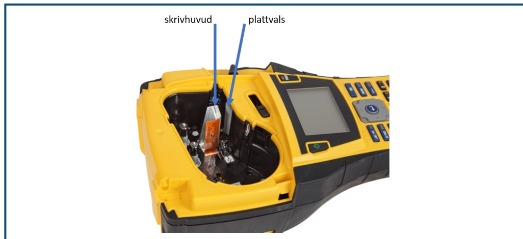
Figur 39 • Skrivhuvud och skrivvalsen i kassetttöppningen
