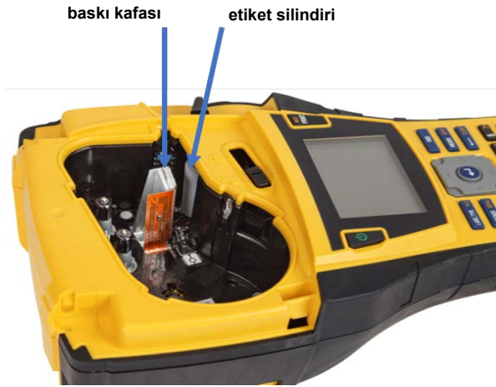
Şekil39 • Kartuş bölmesindeki yazıcı kafası ve kağıt silindiri
