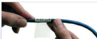
Avvolgere la parte trasparente attorno al filo a coprire l'area stampata.
