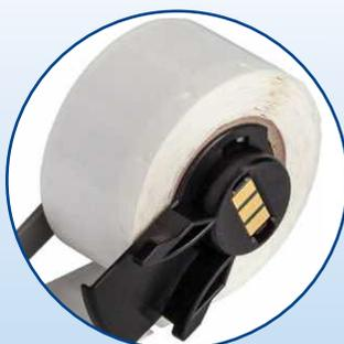
Grazie alla tecnologia SmartCell incorporata nei nastri e nei rotoli di etichette, le stampanti sono in grado di formattare automaticamente l'etichetta e posizionare perfettamente gli oggetti senza bisogno di interventi da parte dell'utente. Se etichette e nastri non sono compatibili, lo schermo visualizza un messaggio di errore.
