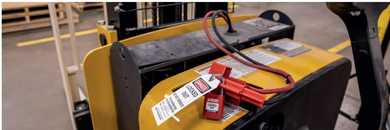
Fácil de utilizar y aplicable en una amplia variedad de vehículos industriales, el bloqueo del conector de alimentación BatteryBlock es una magnífica incorporación a su kit de herramientas de seguridad para tareas de mantenimiento.
