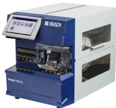
Принтер-аппликатор для маркировки проводов Wraptor A6500
