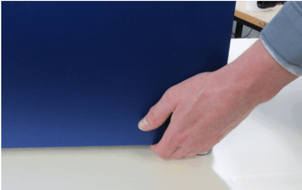
Abbildung 3: Anheben NUR an der Grundplatte
