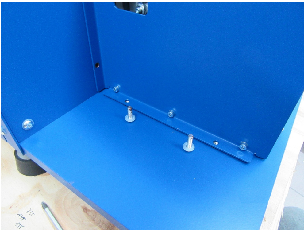
Abbildung 12: Etikettiereinheit zum Befestigen positioniert
