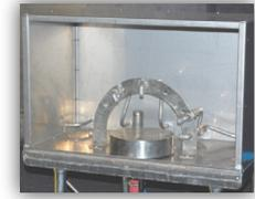
**Figura 2.** Configuración de boquilla de rocío para sistemas de simulación IP69K e imagen de un sistema real de rocío.
