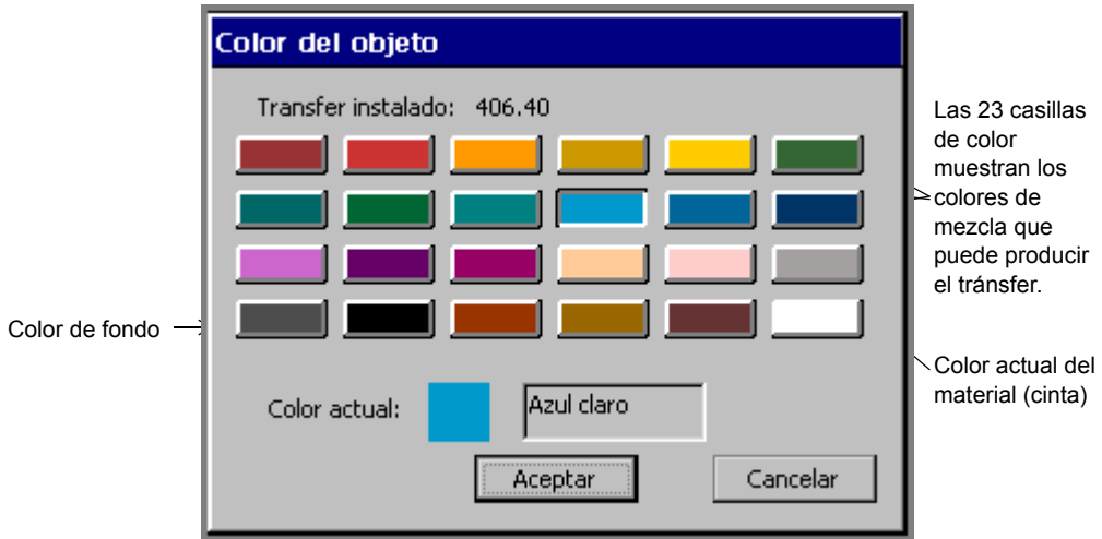
Figura 7-4. Pantalla Color de objeto con tr nsfer CYMK en el sistema Color & Cut
