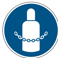
Gasflessen vastmaken M046
