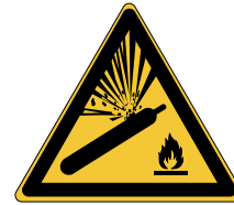
Gashouders onder druk W029
