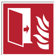
Brandwerende deur F007
