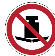
Geen zware last plaatsen P012
