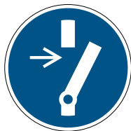
Vrijschakelen voor onderhoud of herstelling M021
