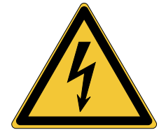
Gevaarlijke elektrische spanning W012
