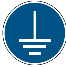
M005: Erdung erforderlich
