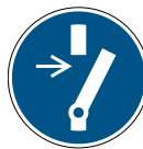
M021: Vor Arbeiten freischalten
