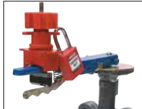
Se coloca en manijas de mariposa, evitando que el gatillo de la manija sea presionado. La válvula no se puede volver a colocar.
