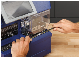
Imprimante avec applicateur Wraptor A6500 pour l'identification de fils
