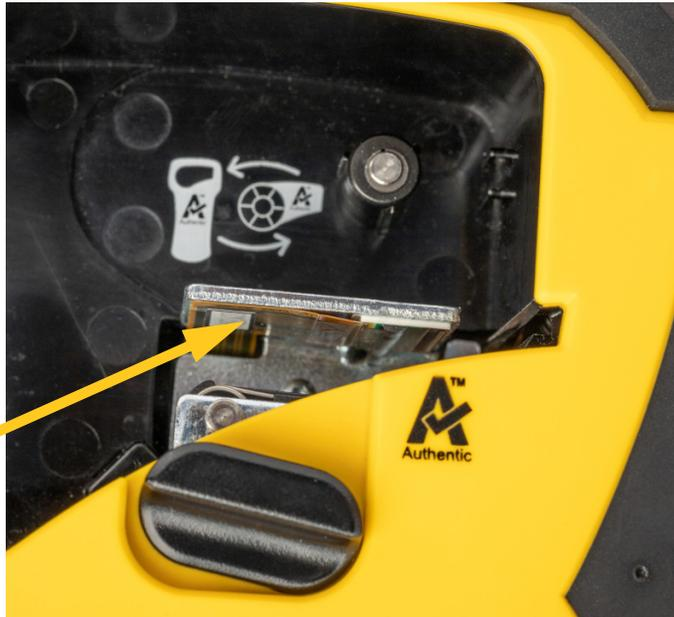
5. Usando sempre un tampone inumidito, strofinare con delicatezza il rullo portacarta. Può essere necessario spostare la leva di bloccaggio nella posizione di blocco per accedere al rullo portacarta.
