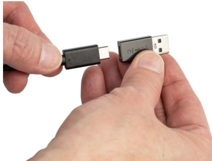
3. Conecte el acoplador USB a un puerto USB-A de un ordenador o de un vehículo.
