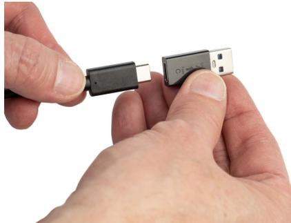
3. Branchez le coupleur USB sur un port USB-A d'un ordinateur ou d'un véhicule.
