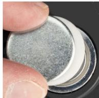
2. Positionnez l'aimant à l'arrière de l'imprimante de manière à ce que les trous de vis soient alignés.
