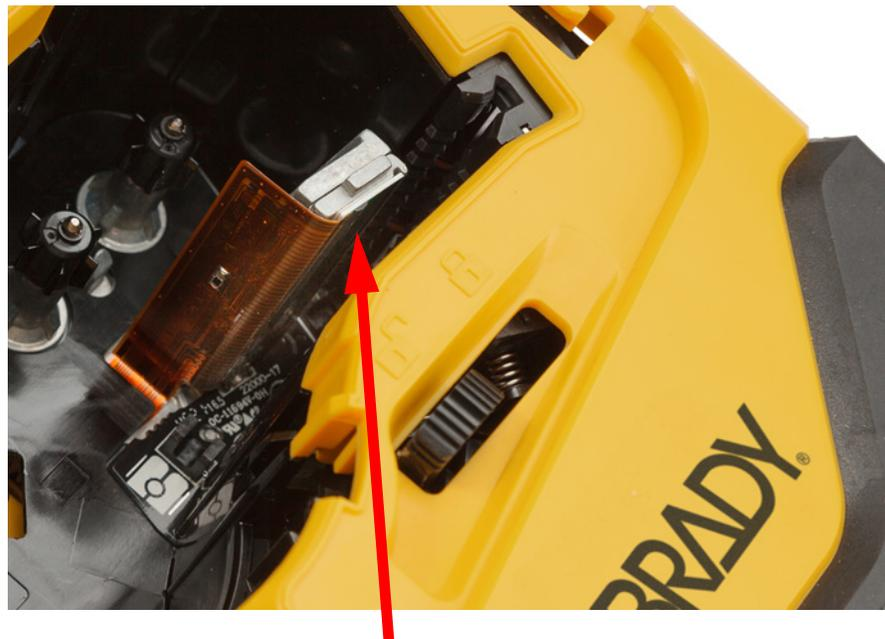
5. Brossez doucement le cylindre avec un coton-tige propre. Placez le levier de verrouillage en position Verrouillé pour accéder au cylindre.
