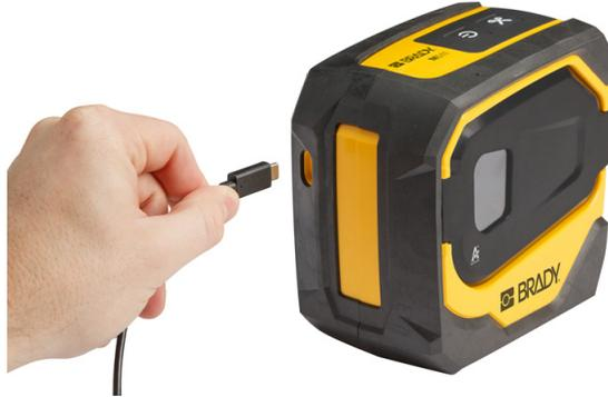
2. Insérez l'autre extrémité du câble USB-C dans le port USB-C du coupleur USB-C vers A.
