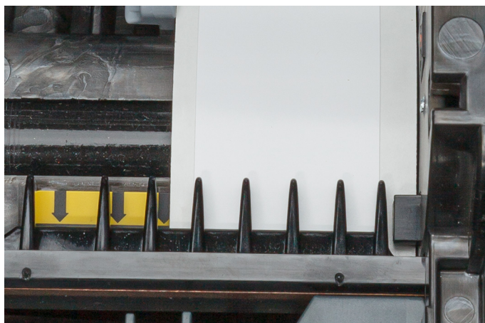
Obrázek 2-2. Umístění zaváděcí hrany zásoby etiket.
