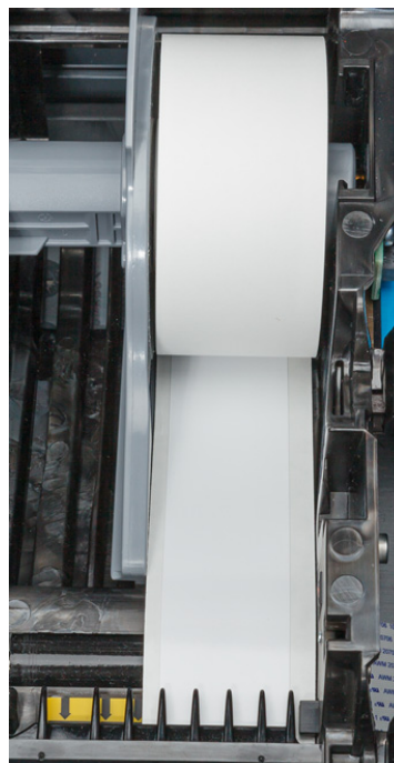
Rys. 2-2. Położenie krawędzi wiodącej materiału etykiet.
