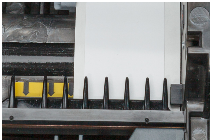
Rys. 2-2. Położenie krawędzi wiodącej materiału etykiet.
