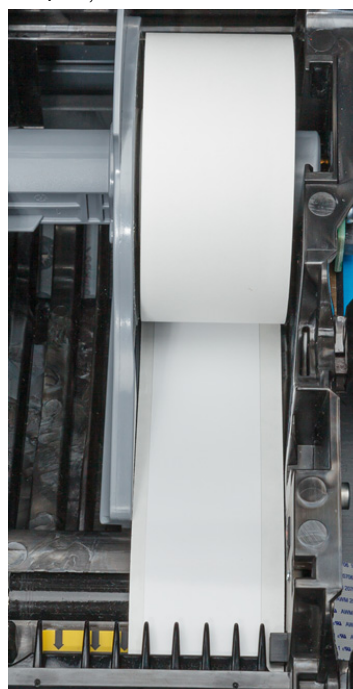
Figura 2-1. Asigurați-vă că senzorii sunt acoperiți.
