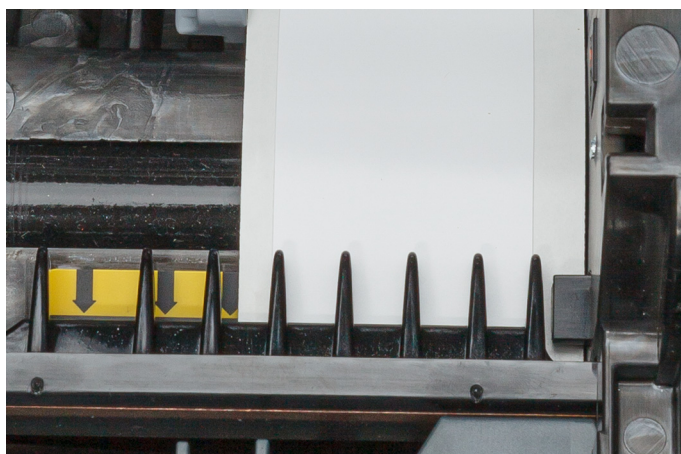
Figura 2-2. Poziționați marginea de început a consumabilului de etichete.
