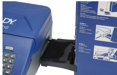
5. Abra la impresora e inserte el centro de la etiqueta asegurándose de que la célula inteligente del rollo de etiquetas se alinee con el lector en el compartimento de la etiqueta.
