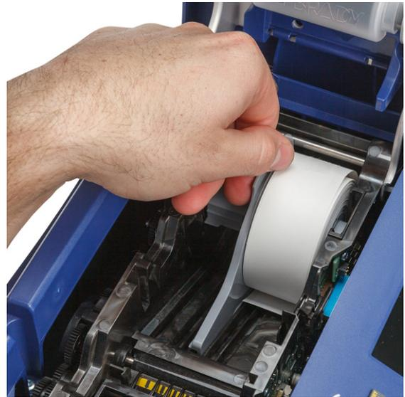
4. Inserte el extremo suelto de la etiqueta hasta la línea negra debajo de las pestañas asegurándose de que el material de la etiqueta cubra los sensores y que el borde del suministro de la etiqueta se alinee más o menos con el costado del compartimento de la etiqueta.
