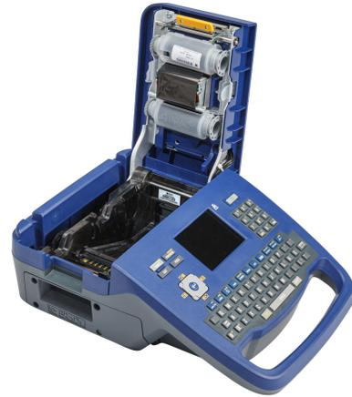
2. Retire las etiquetas existentes, si hubiera. Agarre el rollo de etiquetas y tire suavemente hacia arriba hasta sacarla del compartimento de las etiquetas.
