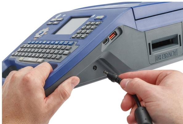
3. Enchufe el otro extremo del cable a un toma de corriente.
