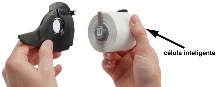
2. Empuje suavemente el adaptador para fijarlo en el centro.
