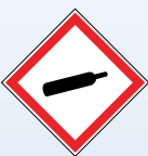
GHS 04 Gaz sous pression Gaz liquéfiés Gaz liquides réfrigérés Gaz dissous
