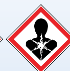
GHS 08 Sensibilisation respiratoire Mutagénicité sur les cellules germinales Cancérogénicité Toxicité pour le système reproductif Toxicité spécifique pour certains organes cibles Danger par aspiration
