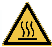
W017 - Danger : Surface chaude
