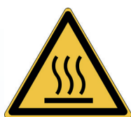
W017 - Danger : Surface chaude
