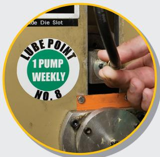
Por ejemplo, una lubricación inadecuada – mucha o muy poca – es una causa importante de fallas en equipo. Una etiqueta simple de lubricación puede ahorrar a su empresa
