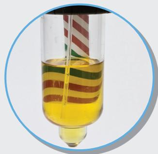
También se pueden aplicar indicadores de nivel de aceite a visores de tubo para simplificar la gestión de aceite. El uso de etiquetas con franjas verdes y rojas colocadas detrás de tubos con visor permite que el operador detecte con facilidad cuando los niveles de aceite son muy altos o muy bajos.
