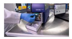
L'imprimante avec applicateur d'étiquettes pour tubes peut étiqueter les tubes deux fois plus vite qu'un processus d'application manuelle d'étiquettes. Les étiquettes sont imprimées et appliquées en quelques secondes sur les tubes de 10 à 17 mm de diamètre et de 38 à 105 mm de long. Une fois étiquetés, les tubes sont éjectés dans un bac ou retirés manuellement. L'impression et l'application d'étiquettes pour tubes peut être déclenchée avec une pédale, un capteur ou un contrôleur programmable.
