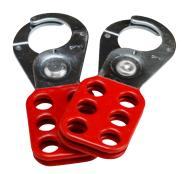
В сумке также имеется множитель для блокировки и маркировки (LOTO), который позволяет навешивать несколько замков на одно универсальное миниатюрное устройство блокировки автоматических выключателей. Это позволит сохранять выключенное состояние оборудования до тех пор, пока все занятые в выполнении работ специалисты по техобслуживанию не завершат свою работу и не снимут свои персональные замки.
