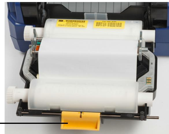
3. Če je rumeni brisalnik potrošnega materiala [3] zataknjen, ga potisnite proti zadnjemu delu tiskalnika.
