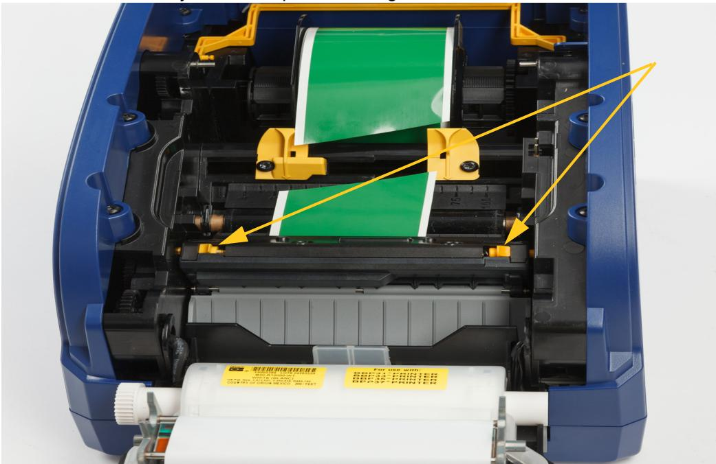
3. Mehanizem rezalnika zavrtite v nasprotni smeri urinega kazalca, da spustite rezilo.
