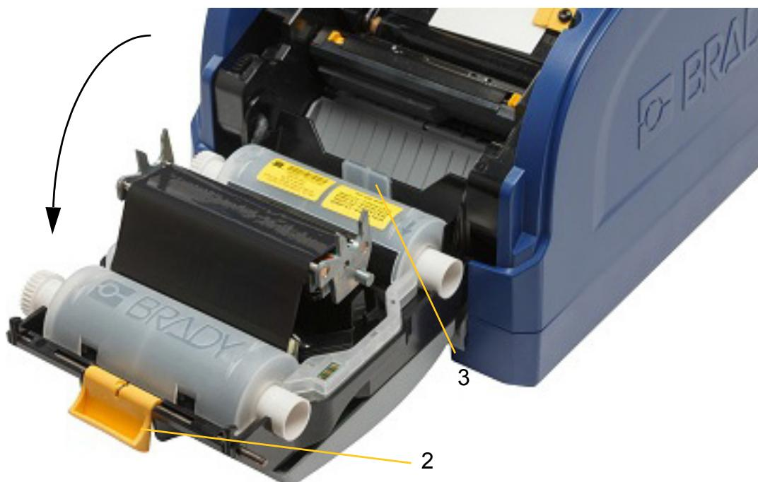
4. Kaseto s trakom namestite prek tiskalne glave (nalepka izdelka proti napravi), nato pa jo zaskočite na njeno mesto.
