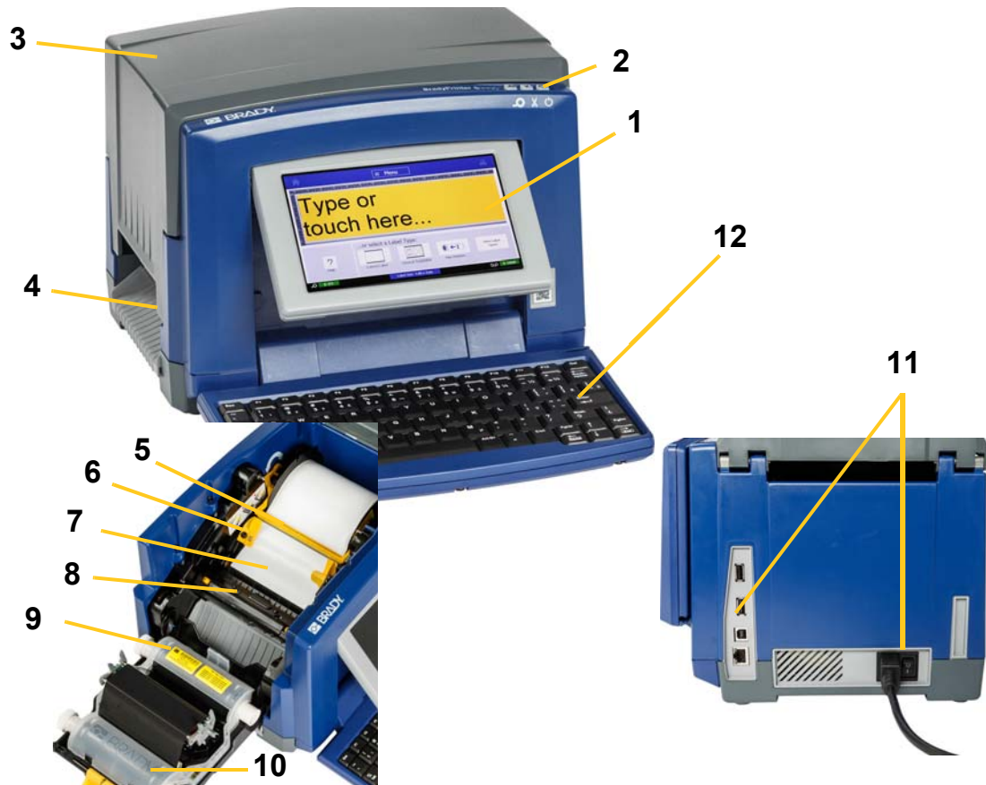
Figura: Componentes de la impresora
