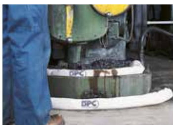
Rozwiązanie: Rękawy szybko pochłaniają wycieki i kapiące substancje pozostawiając czyste i bezpieczne środowisko pracy.
