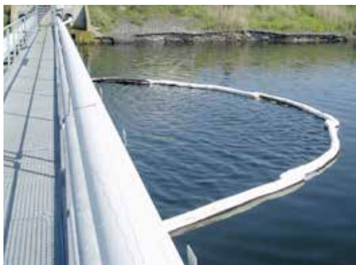
Połączone zapory tworzą barierę wokół rozlewu, uniemożliwiając jego rozprzestrzenianie się.
