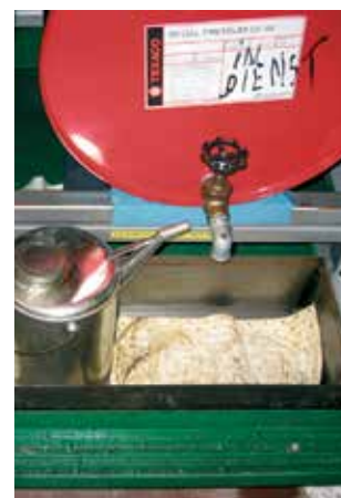
Maty Oil Plus (do oleju i innych substancji) pod kanistry i beczki z olejem do wychwytywania niewielkich skapnięć.
