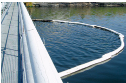
Meerdere slangen vormen een barrière om de gemorste olie in te dammen en te controleren.
