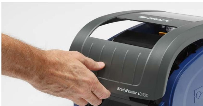
2. Aprire la serratura sullo sportello della testina di stampa [2] e aprire completamente il coperchio.
