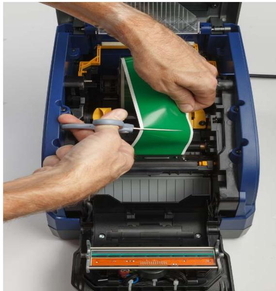
2. Aperte as linguetas para libertar e inclinar o módulo do dispositivo de corte.
