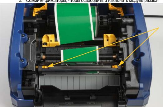
2. Сожмите фиксаторы, чтобы освободить и наклонить модуль резака.
