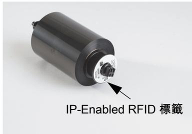
Brady IP-Enabled 色帶的部件號首碼中具有 "IP-"，並且在芯部末端帶有 RFID 標籤，其中包含特定於此部件和墨水系列的資訊。i5100 的 Brady 模式列印將在印表機螢幕上告知使用者已安裝的色帶系列（例如：R64XX）、估計剩餘量，並且在安裝了不適用於所安裝標籤部件的錯誤色帶時會發出警告。如果使用了非 IP-Enabled 色帶，則需要使用特殊配接器芯，並且印表機將預設進行標準模式列印。
