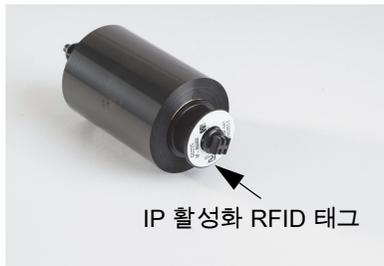
Brady IP 활성화 리본은 부품 번호에서 "IP-" 접두사를 가지고 해당 부품 및 잉크 시리즈에 특정한 정보를 포함한 코어 끝에 RFID 태그가 있습니다. i5100의 Brady 모드 인쇄는 설치된 리본 시리즈 (예: R64XX)의 프린터 화면에서 사용자에게 남은 예상치를 알려주고, 설치된 라벨 부품에 대해 잘못된 리본이 설치된 경우 경고합니다. 비IP 활성화 리본이 사용되는 경우, 특수 어댑터 코어가 필요하며 프린터는 기본적으로 표준 모드 인쇄로 지정됩니다.
