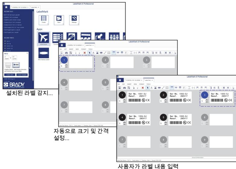
Brady 라벨 생성 소프트웨어 프로그램 LabelMark™와 Brady 워크스테이션은 BradyPrinter i5100과 함께 작동하도록 설계되었습니다. Brady 모드 인쇄에 있을 때, 소프트웨어가 자동으로 설치된 라벨 부품 번호를 감지하고 해당 부품에 대한 라벨 템플릿을 자동으로 찾습니다. 한 번 클릭 시 부품의 크기, 인쇄 영역 및 방향(예: 다중)이 PC 화면에 표시되고 텍스트 입력 준비가 됩니다. RFID 태그가 없는 공급품이 Brady 소프트웨어와 함께 사용되면 프린터는 사용된 공급품에 따라, 부분 Brady 모드 또는 표준 모드 인쇄에서 가능합니다.
