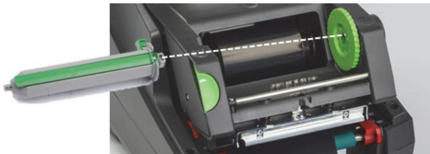
**Passa a Fita em torno do Módulo de Impressão para o Eixo de Recolha**
