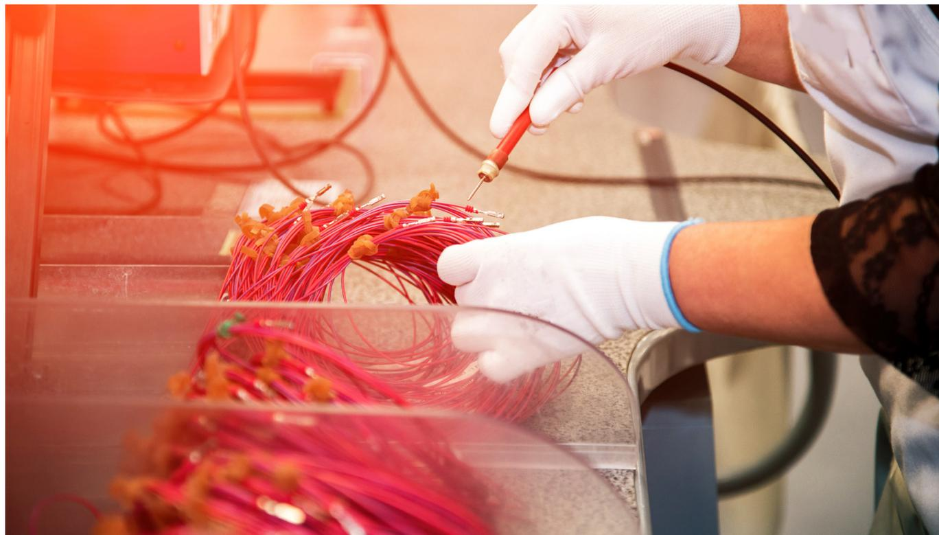
I produttori di cablaggi investono ore di manodopera qualificata per fornire cablaggi compatti che i clienti possano assemblare in macchinari, veicoli ed elettronica. Manodopera, risorse e tempo sono gestiti con grande attenzione per rimanere competitivi. Il processo di etichettatura dei cablaggi non fa eccezione.
