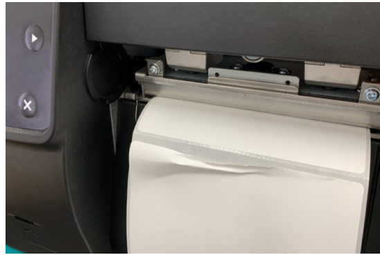
Faltenbildung im Etikett beim Drucken
