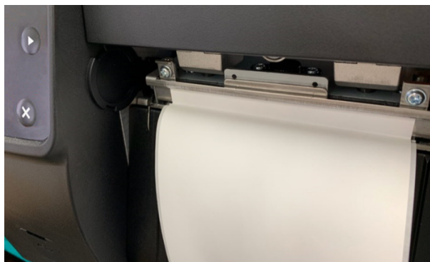
Etikett hängt an der Farbbandführung fest
