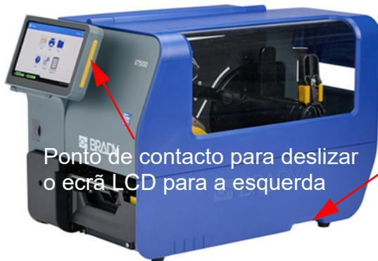
Ponto de contacto para deslizar o ecrã LCD para a esquerda
