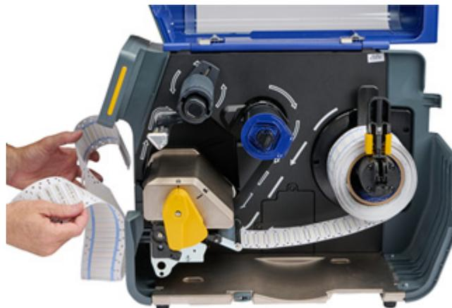
5. Abra a cabeça de impressão utilizando a alavanca amarela, mas **não** remova o rolo de mangas.
