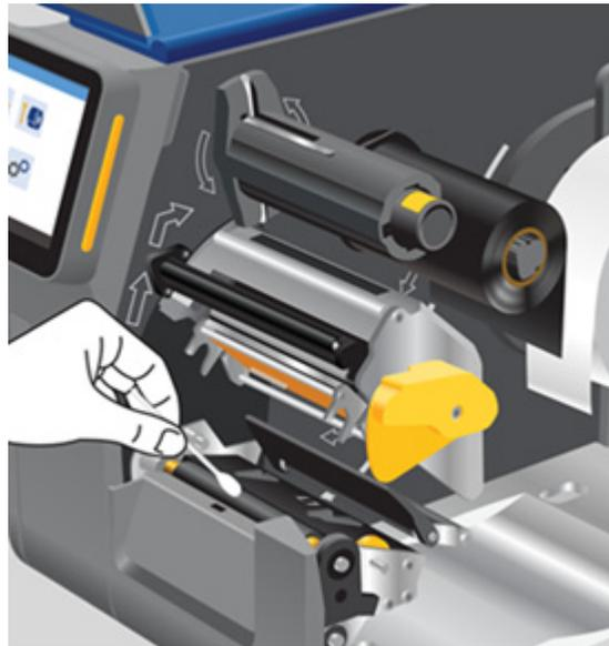
4. Substitua a fita e o rolo de etiquetas após a evaporação do álcool.
