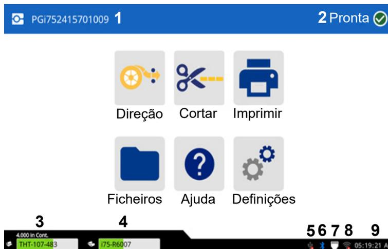
**Nota:** O botão de corte só é mostrado quando o cortador está instalado.
