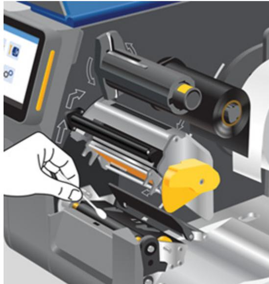
4. Vuelva a colocar la cinta y el rollo de etiquetas después de que se evapore el alcohol.
